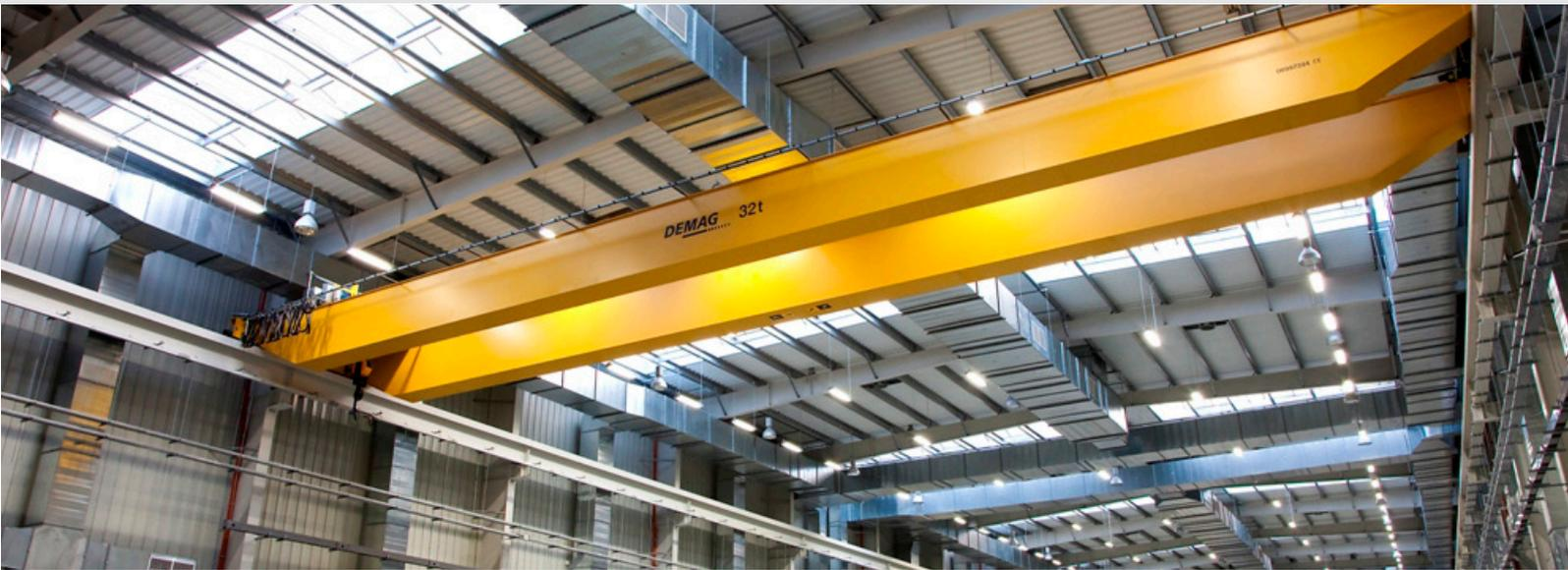
Kranbahnträger werden aus warmgewalzten Doppel-T-Trägern gefertigt. Die werkseitig mit einer unterbrochenen Schweißnaht aufgeschweißte Kranbahnschiene hat die Standardabmessungen von 50 x 30 mm. Die Profile werden nach Güte SA 2.5 stahlgestrahlt und mit einer 80 µm starken Grundierung versehen. Zum Lieferumfang gehören eine prüffähige Statik und Montagepläne.
